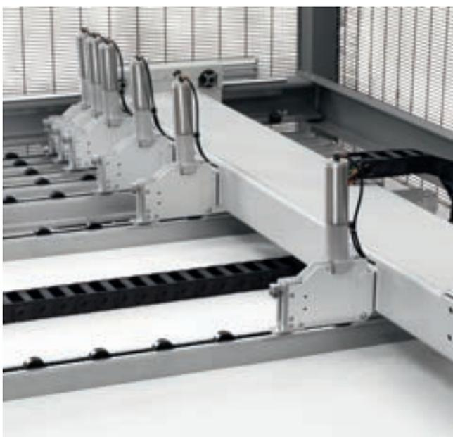
Colocación exacta y rápida de los paneles ofreciendo la máxima precisión de corte gracias al robusto carro empujador. Las pinzas, independientes y autoestabilizadoras, garantizan un fuerte bloqueo de los paneles y permiten la expulsión total de los paquetes cortados fuera de la línea de corte.
