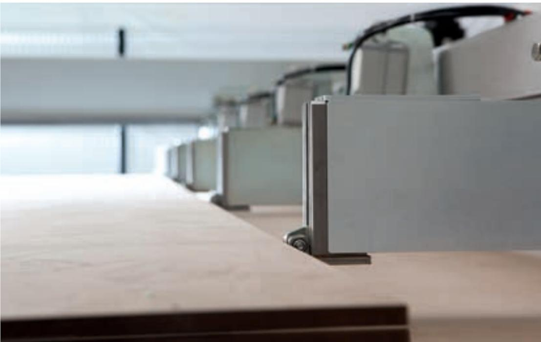
Las pinzas recogen automáticamente la cantidad necesaria de paneles en base al esquema de elaboración incrementando la eficiencia y la seguridad de la seccionadora sin aumentar sus dimensiones.
