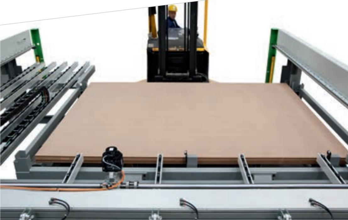
La mesa elevadora, compacta e integrada, permite cargar filas de paneles de hasta 630 mm directamente en los perfiles de acero. La mesa elevadora puede instalarse también en un segundo momento.
